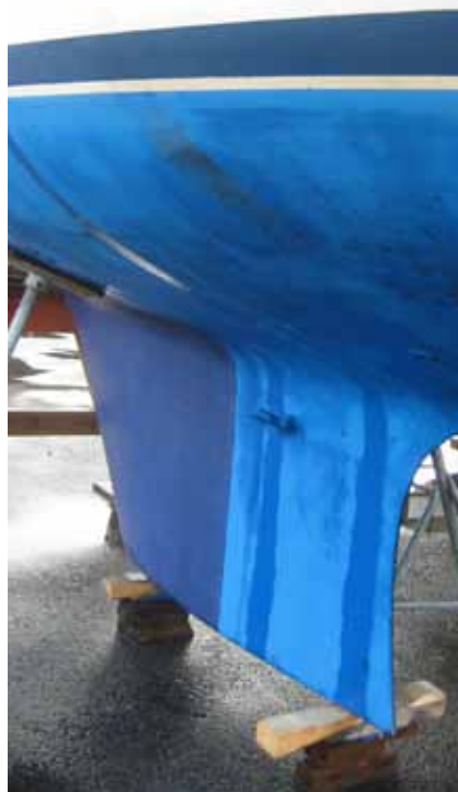
Båtskrov målat med Marine Paints färg med den aktiva substansen medetomidin.
