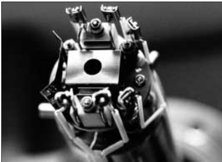
Masspektrometer för in situ kontroll av sammansättningen i \text{Cu(In,Ga)Se}_2 i deponeringsprocessen.
